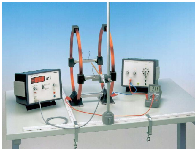
Рис. 1. Установка для изучения свойств магнитного поля колец Гельмгольца
