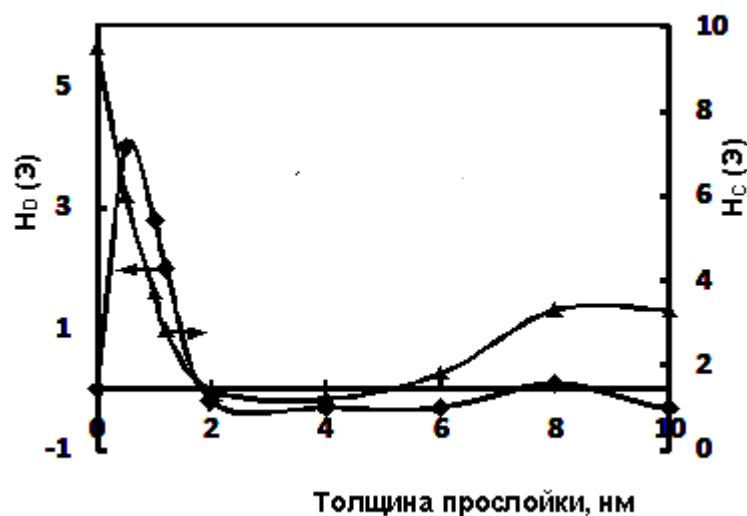
Рис.1. Зависимость коэрцитивной силы и поля связи от толщины прослойки.
