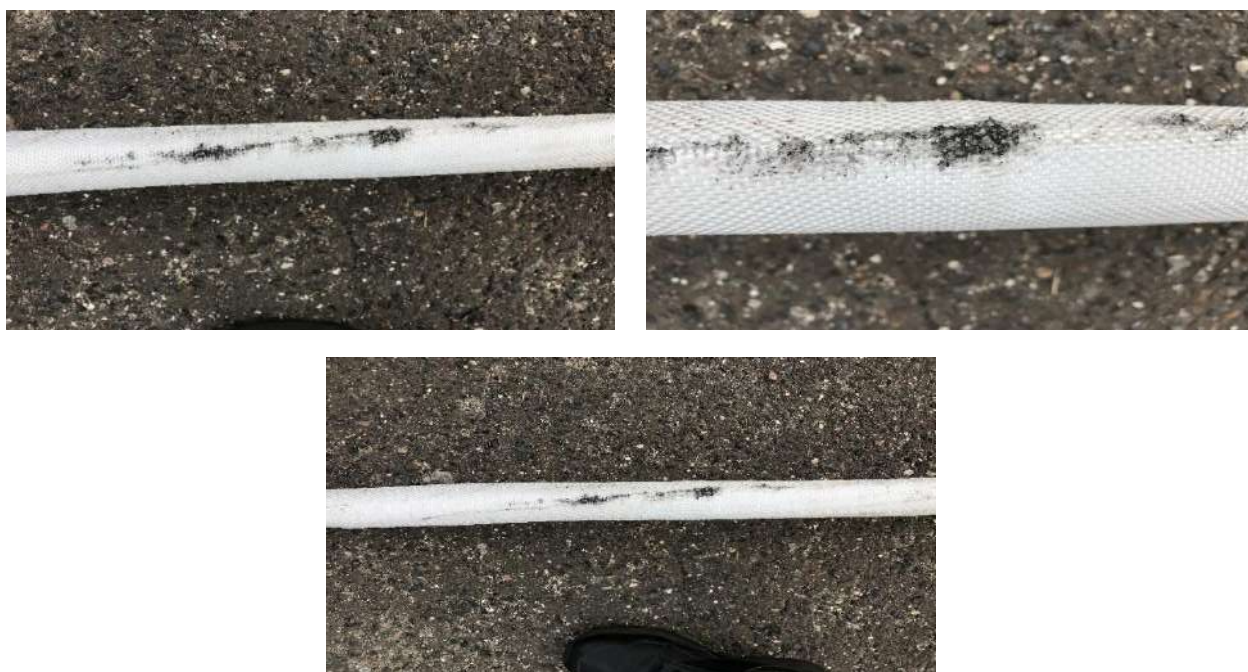
Рисунок 5 – Образование свищей в рукавной линии
