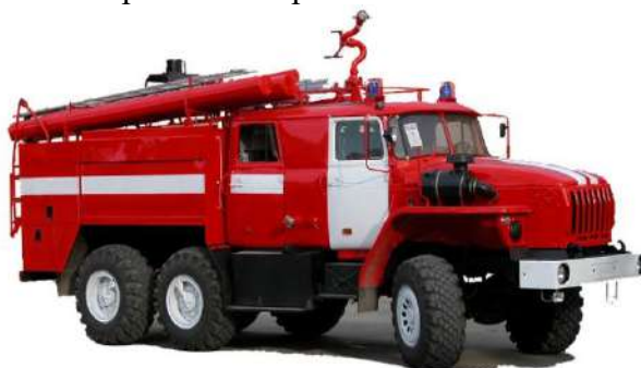
Рисунок 2 - Автоцистерна пожарная бронированная (скрытое бронирование) АЦБ 5,0-40 на шасси Урал 5557
