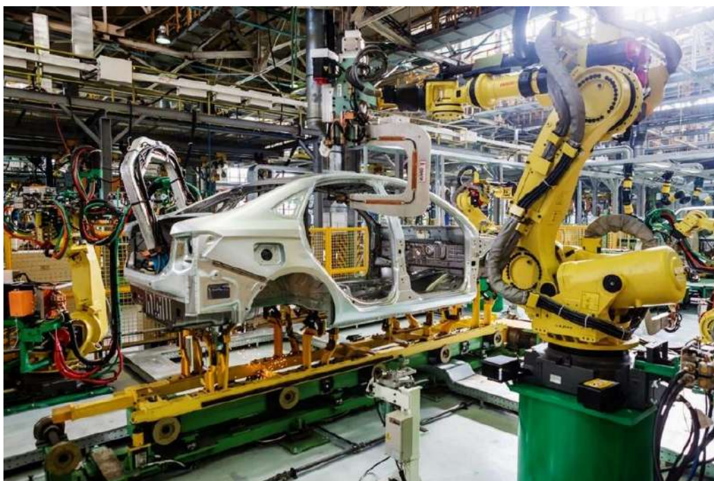
Рисунок 1 – Применение роботов – манипуляторов в сборочном производстве отечественных легковых автомобилей [5]
