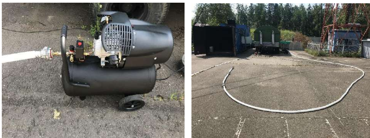
Рисунок 4 – Заполнение рукавной линии сжатым воздухом
