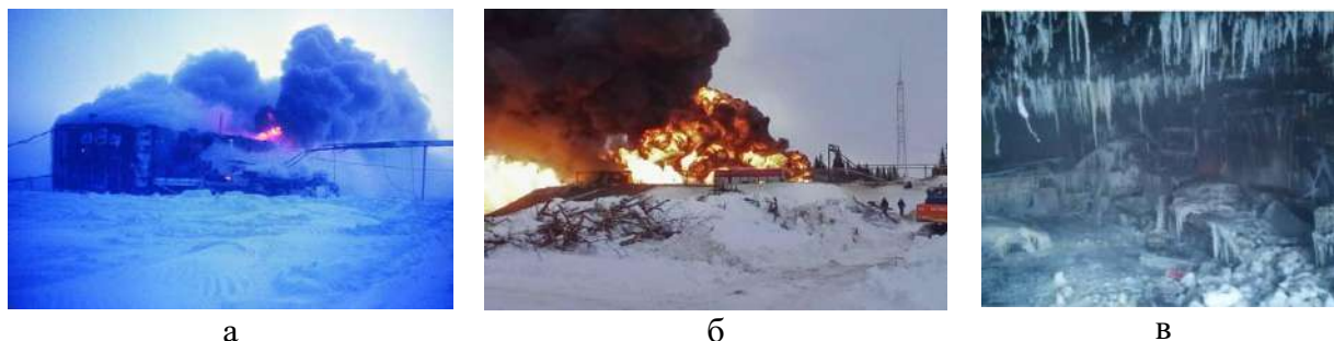
Рисунок 2 – Пожар в арктическом модуле (а), горение резервуара (б) и последствия тушения модуля водой при низкой температуре (в)
