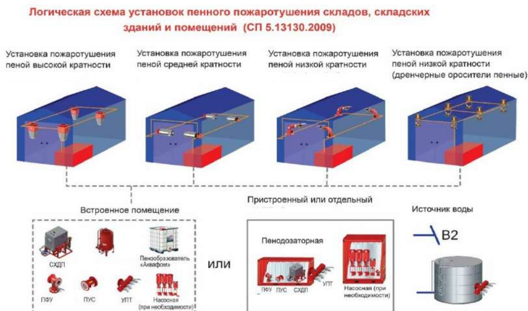
Рис. 2 - Логистическая схема установок пенного пожаротушения складов, складских зданий и сооружений.
