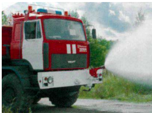
Рисунок 3 - Надбамперная установка тушения со стволом с дистанционным управлением из кабины аэродромного пожарного автомобиля АА-15/60-100/3
