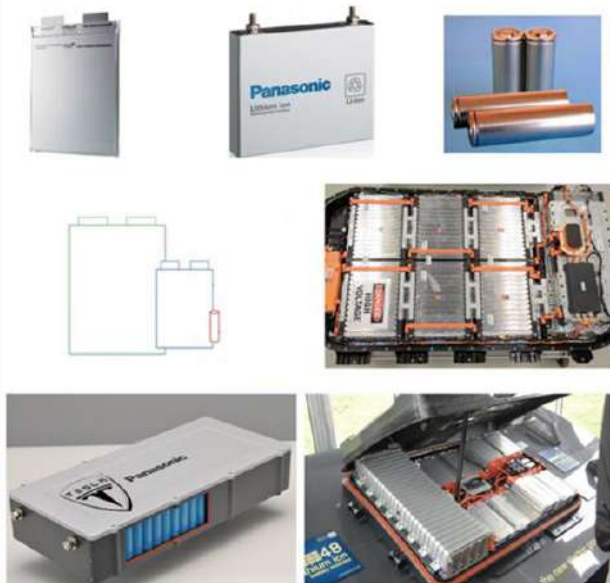
Рисунок 2 – Элементы питания в зависимости от конфигурации и производственного процесса
