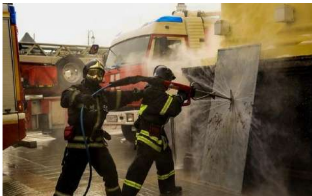
Рисунок 4 – Внешний вид и процесс использования системы пожаротушения «Cobra»
