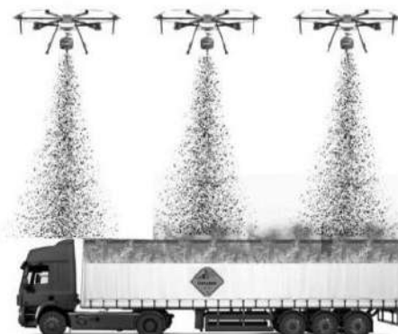
Рисунок 1 - Средство подачи водногелевого огнетушащего состава (ВГС) с помощью БПЛА
