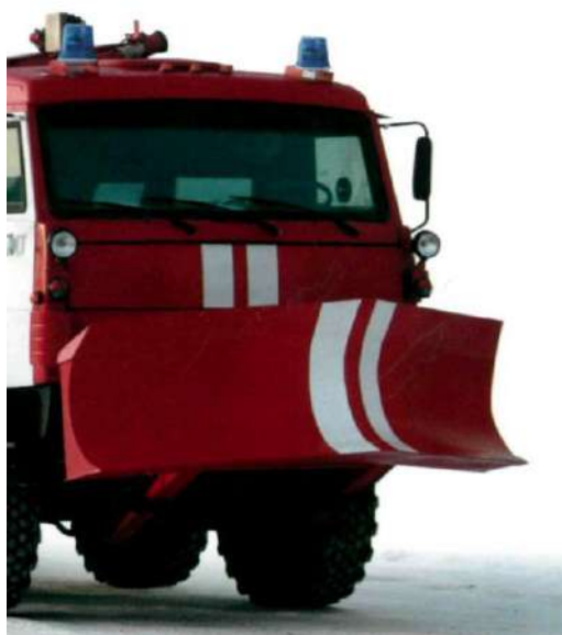
Рисунок 4. Клин-отвал на пожарном автомобиле АПСБ-6,0-40-10
