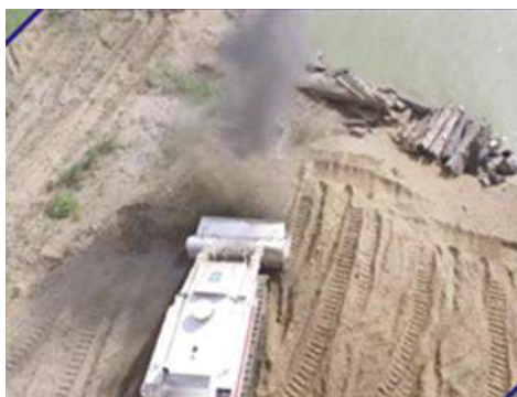
Рисунок 6 – Механическая обезвреживание противопехотных мин роботами РТС–ING MV-4 в зоне СВО
