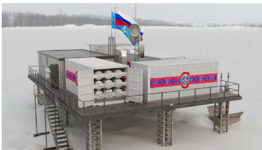
Рисунок 5 - Мобильный газовый контейнер в составе автономного комплекса
