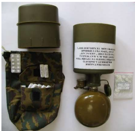
Рисунок 2 – Препарат для очистки и обеззараживания загрязненной воды - «Аквасан». Используется для индивидуального применения в полевых условиях, в составе изделия «Бирюза» (фильтр-фляжка). 1 таблетка на 1-5 л. воды.
