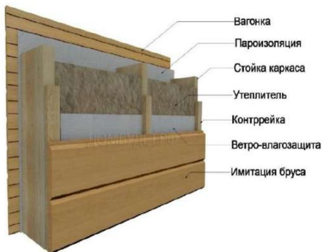
Рисунок 1 – Пример легкой деревянной каркасной конструкции (ЛДКрК)
