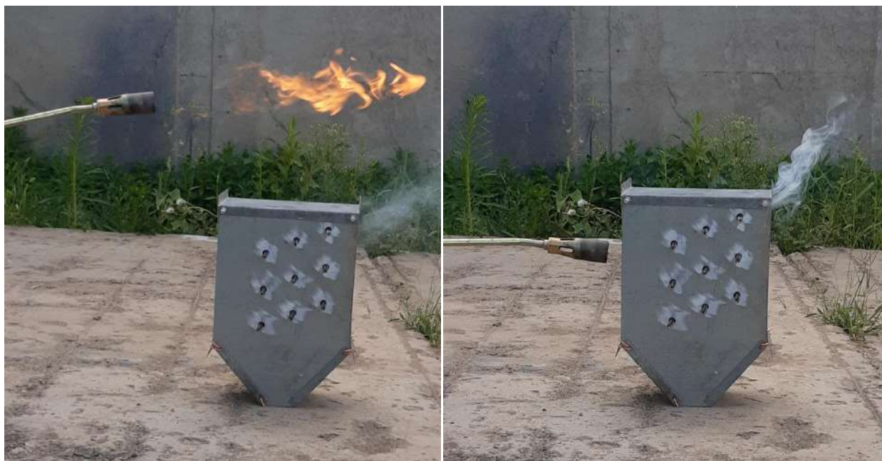
Рисунок 2 - пример работы огнепреградителя «Ёрш»
