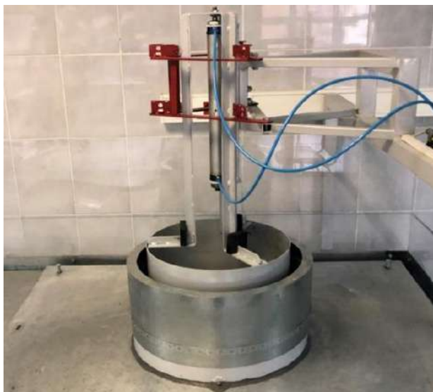
Рисунок 5 – Фрагмент лабораторного стенда для нахождения необходимой высоты защитной стенки РВСЗС в зависимости от ее удаленности от стенки основного резервуара и длины вылета ГВК (а) или НВК (б)
