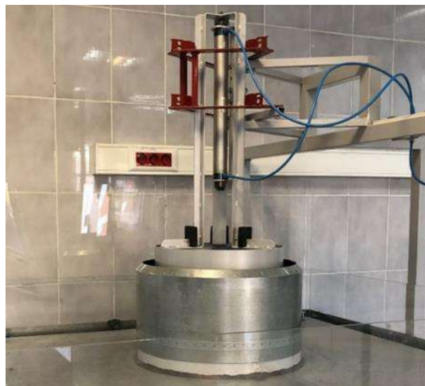
Рисунок 5 – Фрагмент лабораторного стенда для нахождения необходимой высоты защитной стенки РВСЗС в зависимости от ее удаленности от стенки основного резервуара и длины вылета ГВК (а) или НВК (б)
