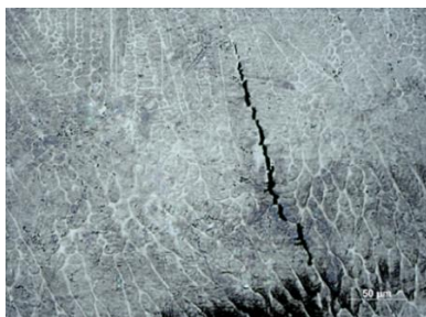
Рис. 2 – Трещина в металле шва при однослойной наплавке
