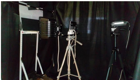
Рис. 1 – Расположение основных элементов установки для теплового контроля (объект контроля, источник нагрева, тепловизор).
