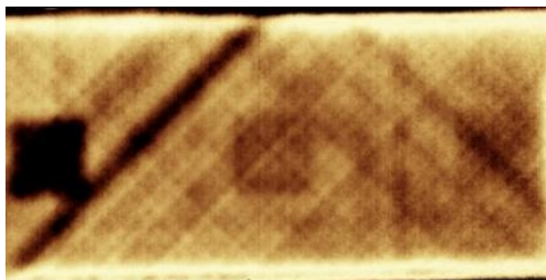
Рис. 3 – Образец КС 17_46-3 (нагрев – 10с, частота – 10Гц).
