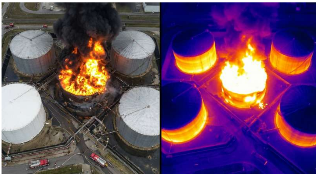
Рисунок – Термограмма резервуарного парка, полученная с БПЛА
