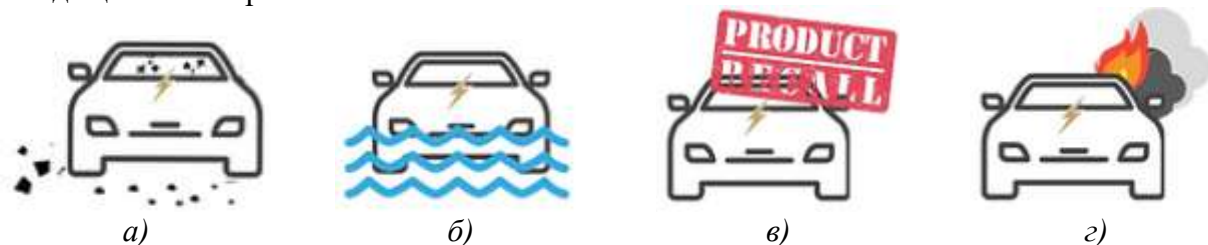
Рисунок 1 – Причины повреждений аккумуляторов, приводящих к возгоранию
