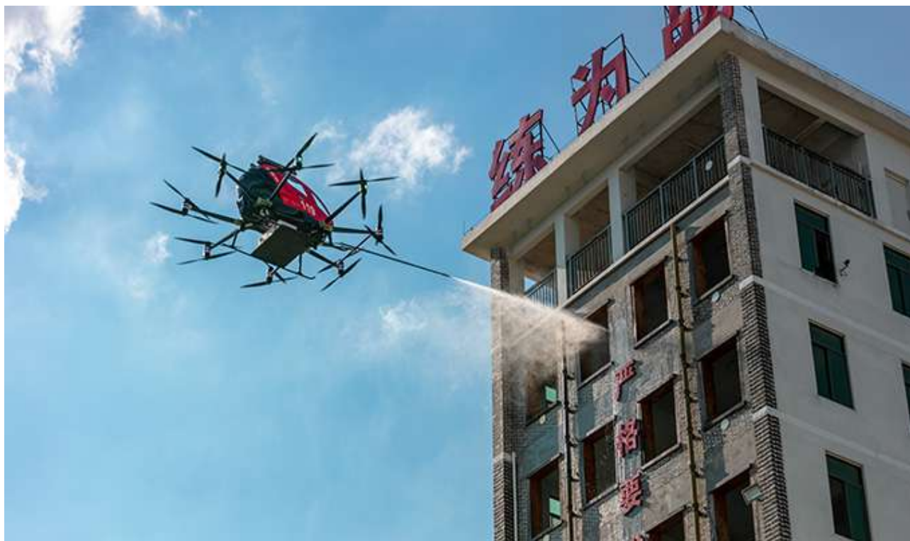
Рисунок 4 – Подача огнетушащего аэрозоля с помощью беспилотного летательного аппарата специальной конструкции на верхние этажи высотного здания
