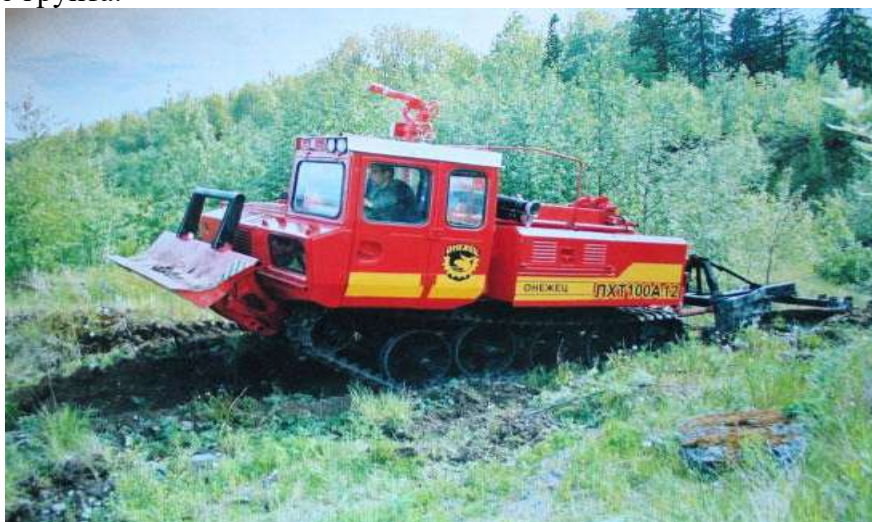
Рисунок 1 – Пример создания лесозащитной полосы с помощью лесопожарной техники
