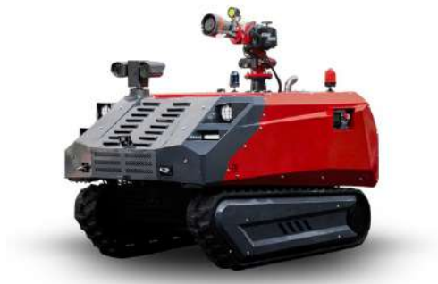
Рисунок 2 – Роботизированные комплексы пожаротушения
