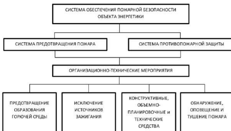
Рисунок 2 – Система обеспечения пожарной безопасности объекта энергетики
