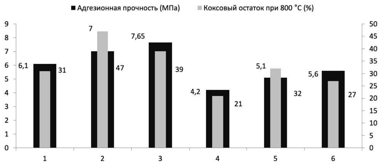
Рисунок – Зависимость адгезионной прочности и выхода коксового остатка от концентрации астраленов: 1-Образец 0 % без крио., 2-Образец 0,5 % без крио., 3-Образец 1 % без крио., 4-Образец 0 % после крио., 5-Образец 0,5 % после крио., 6-Образец 1 % после крио
