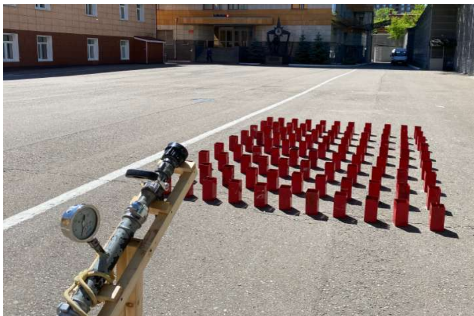
Рисунок 2 – Определение показателей эффективной дальности по ГОСТ Р 53331–2009
