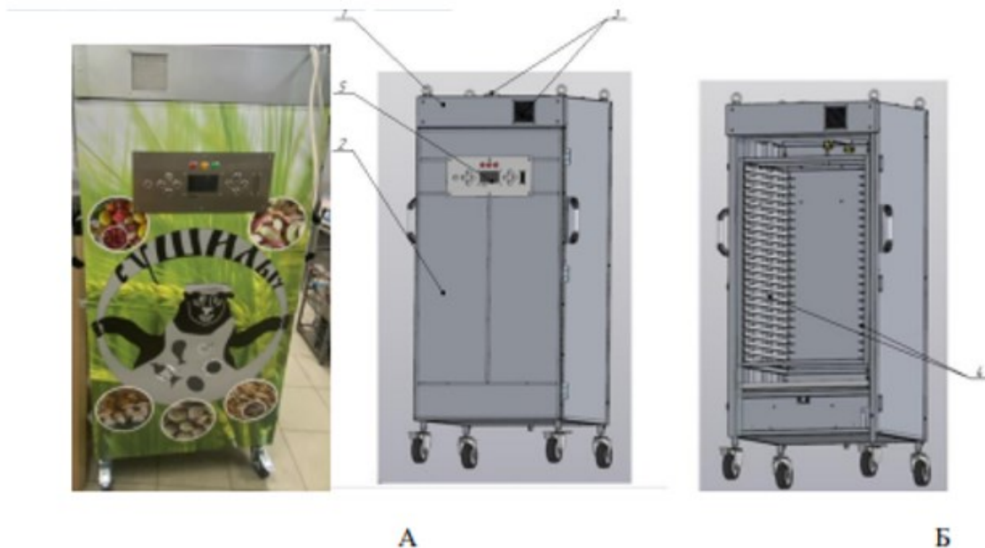
Рис. : 1. А- Общий вид установки; Б - Разрез установки 1- корпус; 2- дверь; 3- вентиляторы; 4- рельсы; 5- дисплей.
