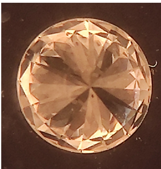
Рис. 2. Картина аномального дупреломления в виде чередование серых и светлых участков в бриллианте
