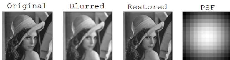
Рис. 1. Пример восстановления слепым методом Люси-Ричардсона
